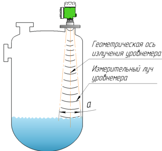
Рисунок. 2.6 – Схематичное изображение измерительного луча
