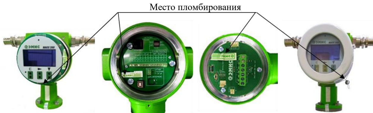
Рисунок 2 – Варианты пломбирования счетчиков-расходомеров,
