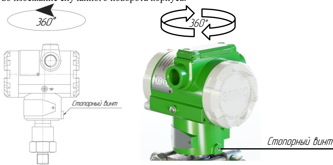
Рисунок 3 – Вращение электронного блока
