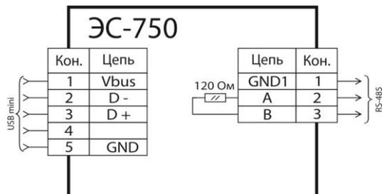
Рисунок 3 — Схема подключения конвертера ЭМИС-СИСТЕМА 750 - RS-485 - USB
