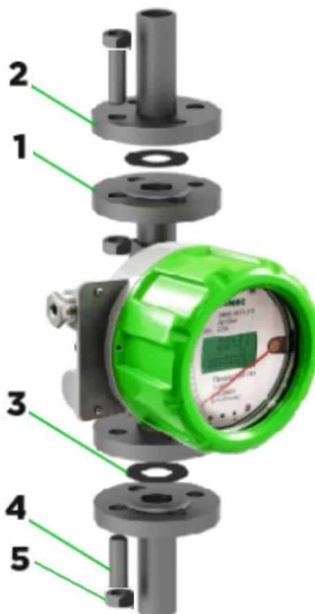
Рисунок 2.6 – Установка ротаметра с фланцевым присоединением к трубопроводу
