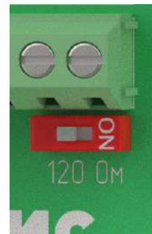
Рисунок 4.3. Схема интерфейса RS-485 (слева) и переключатель терминального резистора (справа) электронного блока исполнения С2/СИП2.
