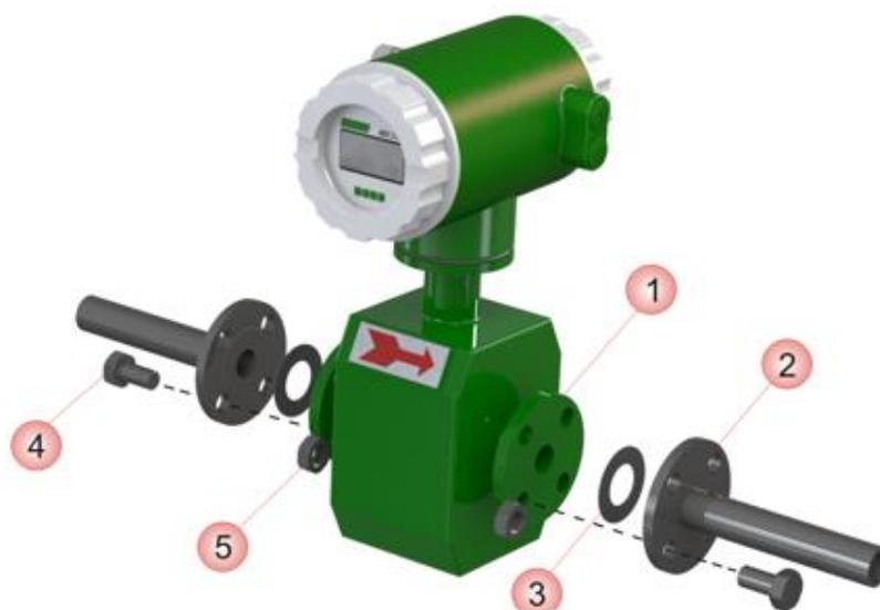
Рисунок 2.3 – Установка расходомера ЭМИС-МАГ 270 на трубопровод
