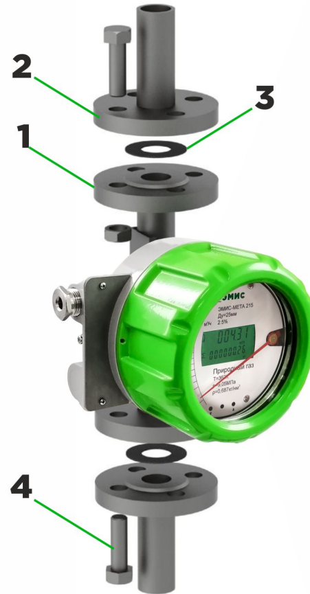
ФЛАНЦЕВОЕ ПРИСОЕДИНЕНИЕ Фланцы - 1 Ответные фланцы - 2 Прокладки - 3 Болты - 4
