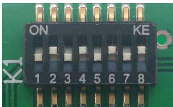
Рисунок 6.4 – Блок защитных переключателей в положении по умолчанию
