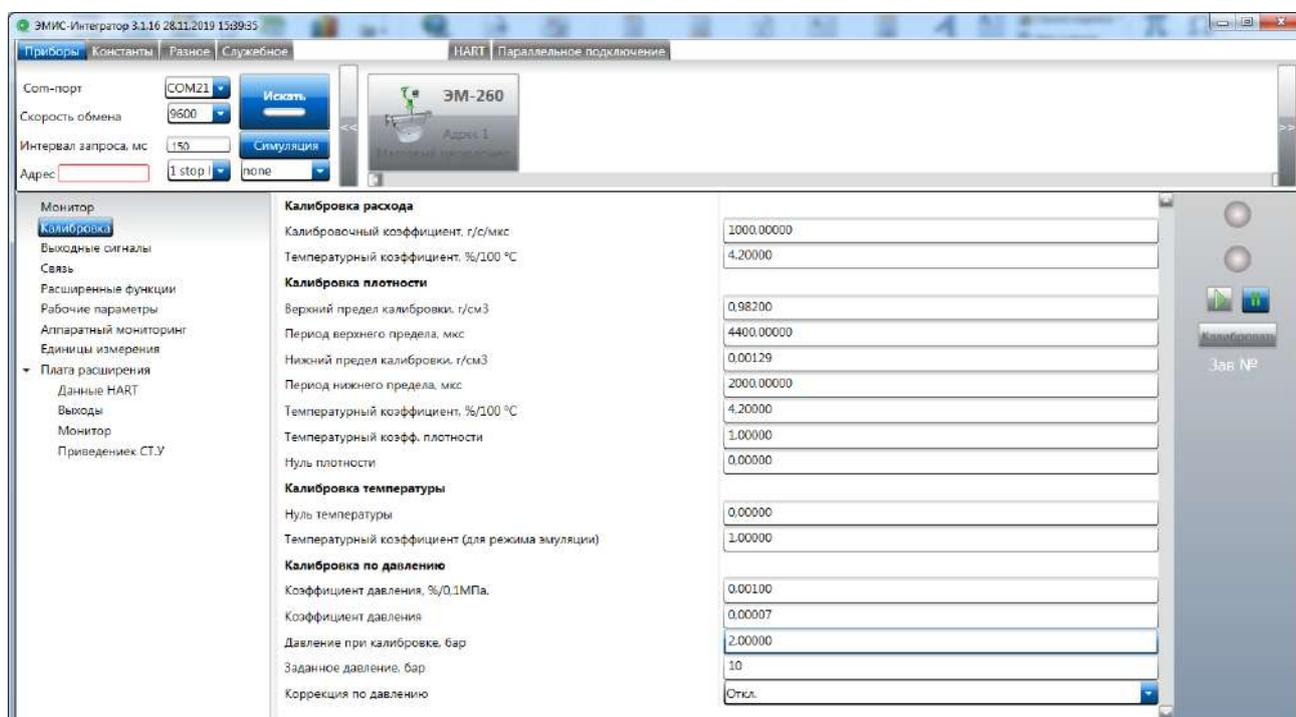
Рисунок 6.3 –ЭМИС-Интегратор с подключенным электронным блоком ЭМИС-МАСС 260
