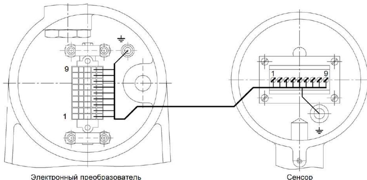
Рисунок 5.3 – Подключение электронного блока дистанционного исполнения к сенсору
