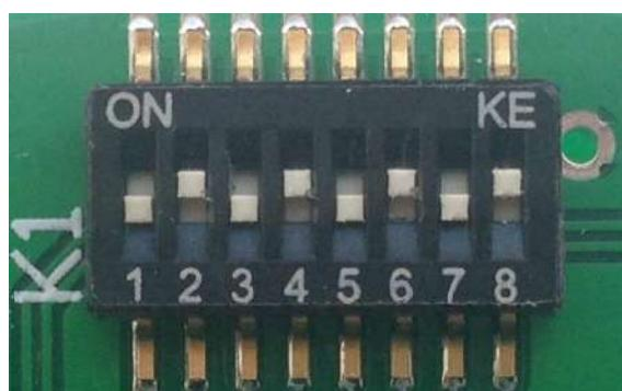
Рисунок 6.4 – Блок защитных переключателей в положении по умолчанию
