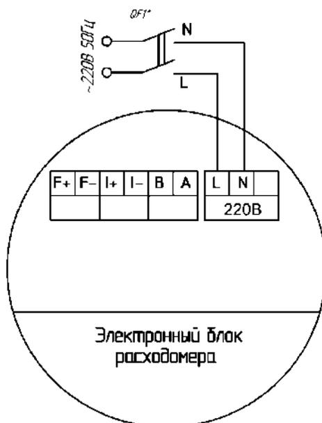
Параметры источника питания: переменное напряжение 182–242В, частота  $50 \pm 1$  Гц. QF1\* – автоматический выключатель, не является обязательным и в комплект поставки не входит.
