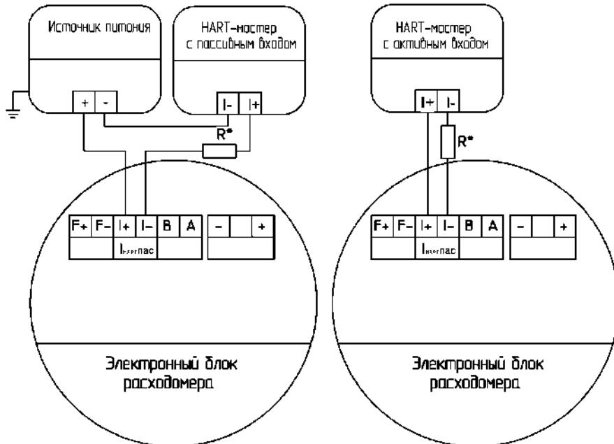
Резистор  $R^*$  номиналом от 240 до 270 Ом и необходим только в случае, если у вторичного оборудования отсутствует встроенный резистор данного номинала. Параметры источника питания (вторичного преобразователя): напряжение постоянного тока 12–24 В, выходной ток не менее 25 мА.
