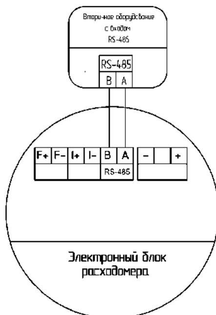
Рисунок 5.18 – Схема подключения электронного блока по интерфейсу RS-485
