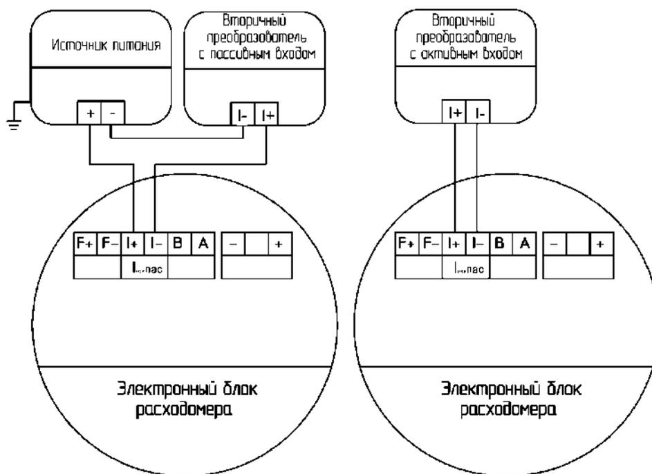
Параметры источника питания (вторичного преобразователя): напряжение постоянного тока 12–24В, выходной ток не менее 25 мА.
