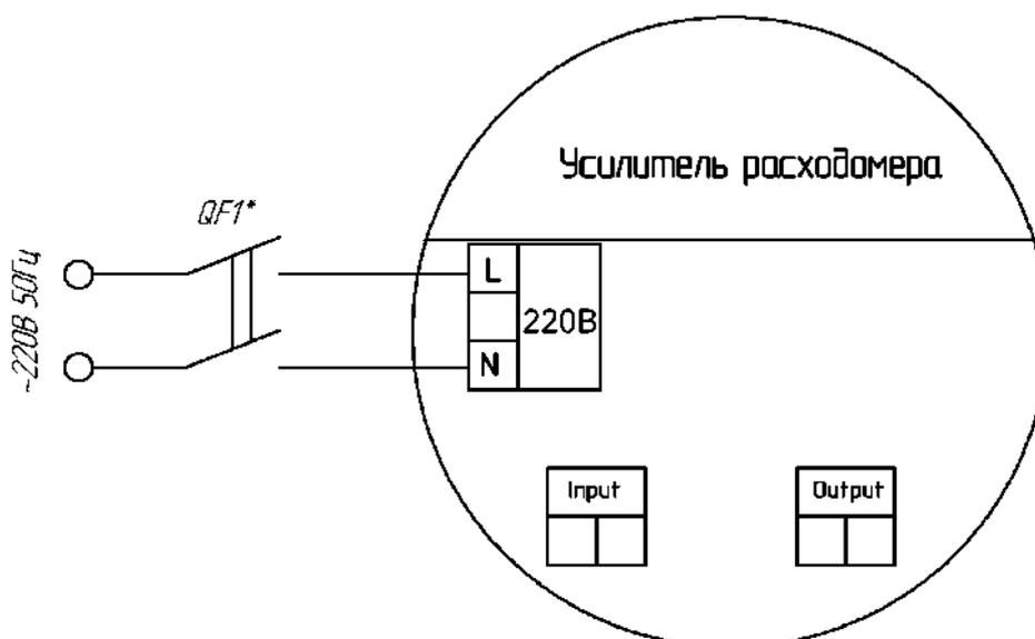
Параметры источника питания: переменное напряжение 182–242В, частота 50±1 Гц. QF1\* – автоматический выключатель, не является обязательным и в комплект поставки не входит.
