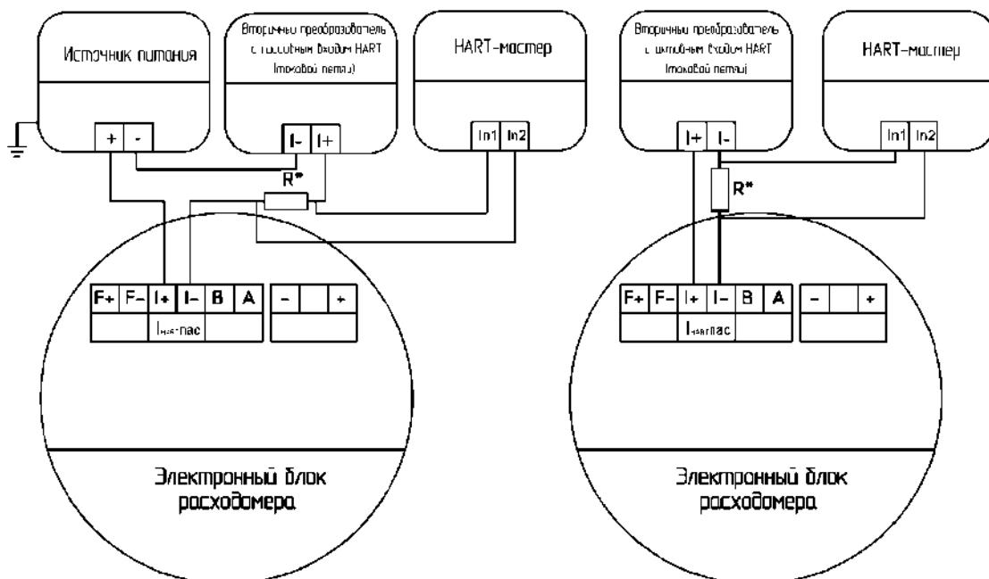
Резистор  $R^*$  – обязательный, номиналом от 240 до 270 Ом. Параметры источника питания (вторичного преобразователя): напряжение постоянного тока 12–24 В, выходной ток не менее 25 мА.
