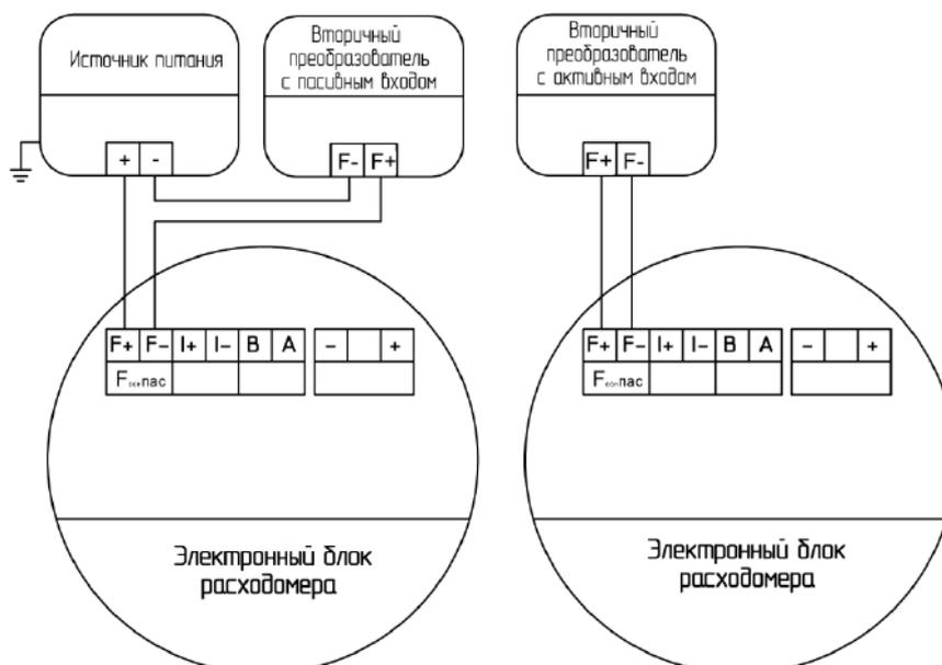
Параметры источника питания и вторичного преобразователя: напряжение питания (выхода) 2,5-24В, максимальный ток через транзистор 100 мА, максимальная частота – 12000 Гц.
