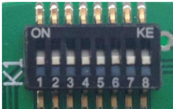
Рисунок 6.5 – Блок защитных переключателей в положении OFF
