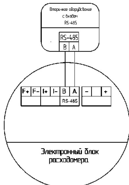
Рисунок 5.18 – Схема подключения электронного блока по интерфейсу RS-485
