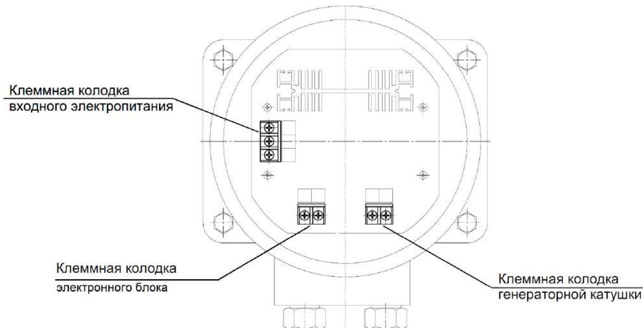
Рисунок 5.4 – Внешний вид усилителя генераторной катушки
