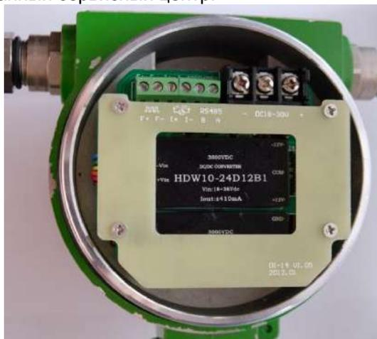
Рисунок 8.1 – Снять плату шильда
