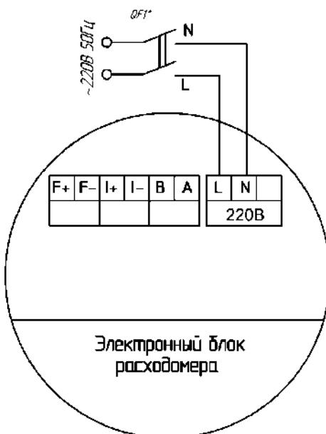
Параметры источника питания: переменное напряжение 182–242 В, частота 50±1 Гц. QF1\* – автоматический выключатель, не является обязательным и в комплект поставки не входит.
