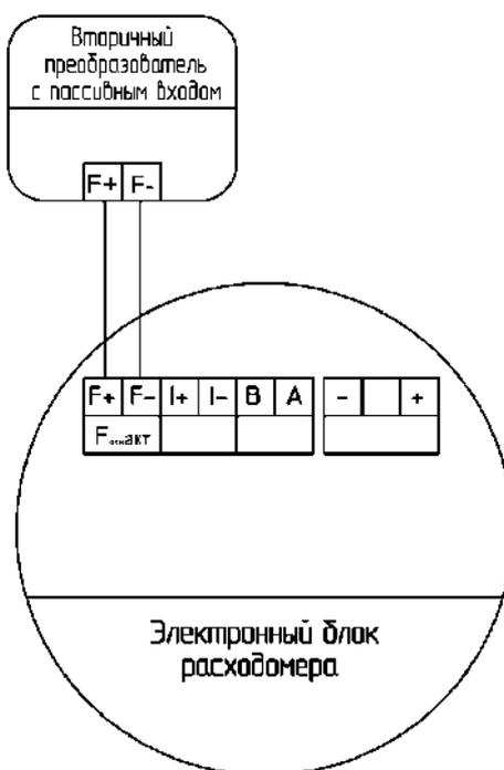
Рисунок 5.11 – Схема подключения электронного блока с активным частотным выходом к приемнику с пассивным входом
