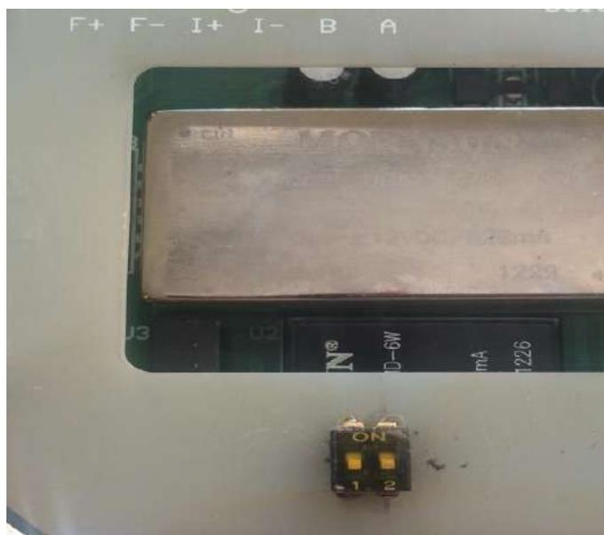
Рисунок 6.6 – Дополнительный блок переключателей (положение OFF)
