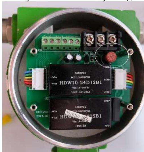
Рисунок 8.2 – Вытащить и проверить указанный предохранитель
