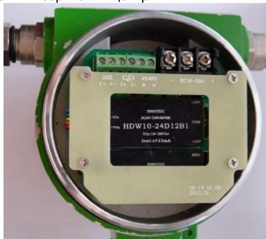
Рисунок 8.1 – Снять плату шильда
