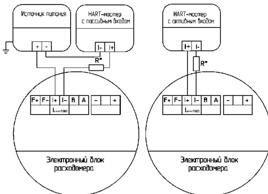
Резистор R\* номиналом от 240 до 270 Ом и необходим только в случае, если у вторичного оборудования отсутствует встроенный резистор данного номинала. Параметры источника питания (вторичного преобразователя): напряжение постоянного тока 12-24В, выходной ток не менее 25 мА.
