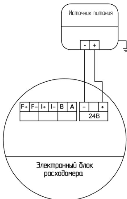
Параметры источника питания: постоянное напряжение 18–30В выходной ток не менее 1А.
