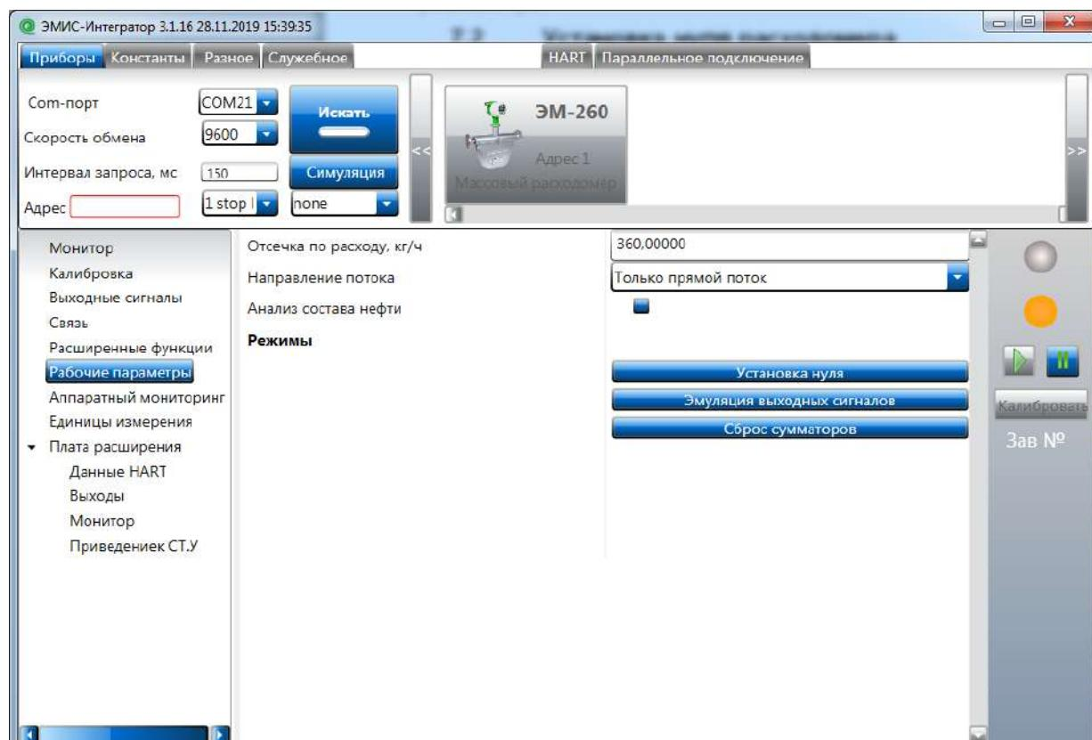
Рисунок 7.1 – Запуск процедуры «Установка нуля» через ПО «ЭМИС-Интегратор»
