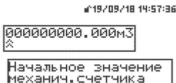
В этом окне при помощи кнопок клавиатуры ▲, ▼, ►, ◀ установите значение механического счетчика и нажмите кнопку *Ввод*. Произойдет одновременный сброс интеграторов и установка заданного значения механического счетчика в интегратор количества в вычислителе.
