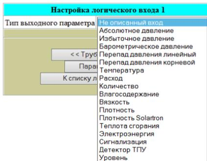
Один логический вход может использоваться в описании разных трубопроводов. Для возврата к описанию параметров трубопровода необходимо щелкнуть мышкой на окно соответствующего трубопровода в окне *Настройка логического входа N*.
