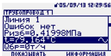
После установки курсора на параметре со значком ~ вход в режим просмотра графика выполняется кнопкой *ВВОД*. Пример вывода такого графика приведен ниже:
