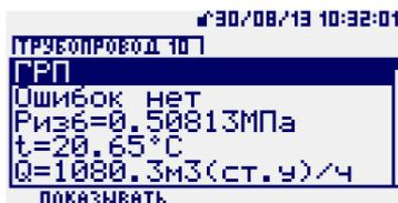
В меню просмотра состояния текущих параметров трубопровода после выбора курсором какого-либо параметра и нажатия кнопки *F1* (*показывать*) выбранный параметр будет отображаться на основном экране в строке соответствующего трубопровода:
