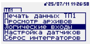
Для просмотра состояния логических входов, использованных в выбранном трубопроводе, необходимо выбрать при помощи кнопок клавиатуры **▲**, **▼** пункт меню *Логические входы* и нажать кнопку **▶**. На индикаторе появится следующее окно:
