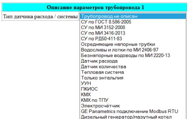
Описание типов датчиков расхода и типов систем для этого пункта:
