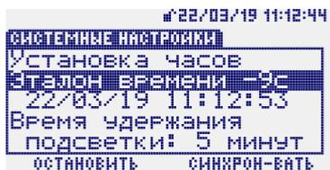
На экране в строке *Эталон времени* индицируется отклонение времени вычислителя от эталонного, указанного в следующей строке. Для синхронизации времени вычислителя с эталонным нажмите кнопку F2 (функция *Синхронизировать*). Изменение времени сохраняется в архивах.
