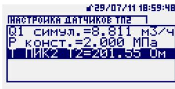
Режим предназначен для проведения настройки датчиков. При работе в этом режиме вычислитель регистрирует факт проведения настройки в архиве как НС и в течение всего времени проведения настройки производит расчет расхода по договорному значению, заданному в карте параметров соответствующего трубопровода. В этом режиме можно просмотреть те же параметры, что и в подпункте *Проверка физических входов*, но в привязке к выбранному трубопроводу.
