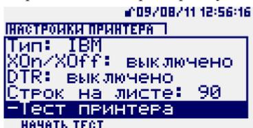
После нажатия кнопки *F1* (функция *Начать тест*) выполняется печать проверочной страницы. На выводимой при тестировании странице строки пронумерованы, что облегчает определение числа строк, помещающегося на странице.
