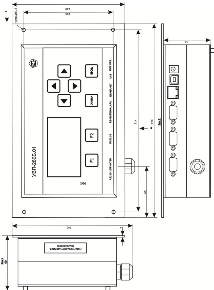
**Приложение 7. Щитовой монтаж БВ вычислителя УВП-280Б.01 (вид сзади)**
