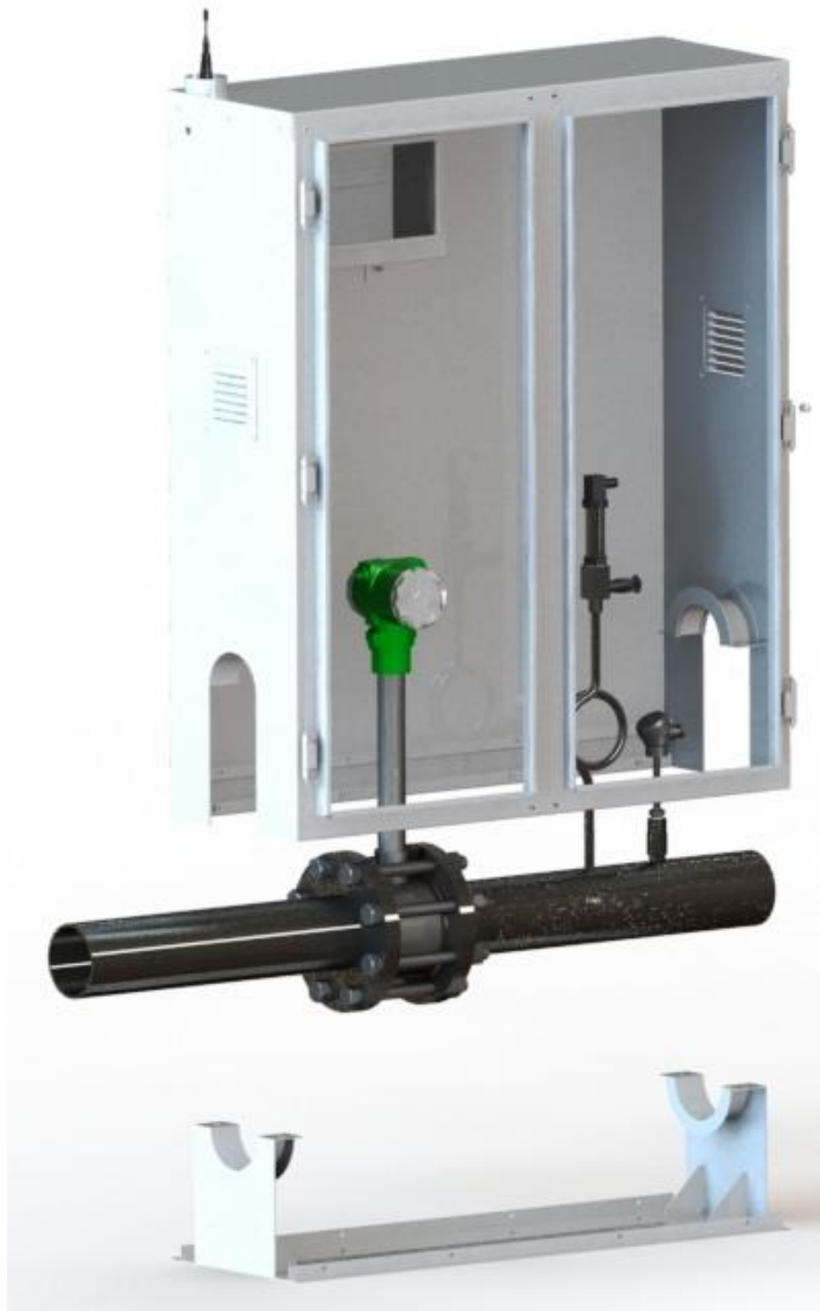
Рисунок 2.9 – Монтаж шкафа на трубопровод
