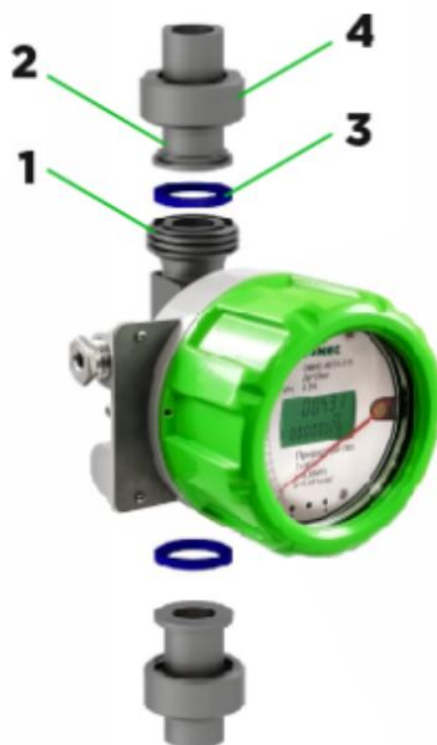
Рисунок 2.8 – Установка ротаметра с муфтовым присоединением к трубопроводу
