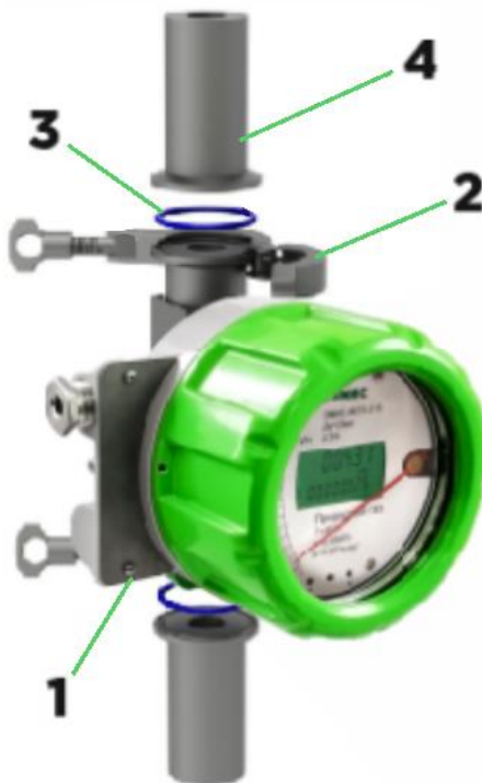
Рисунок 2.9 – Установка ротаметра с зажимным присоединением к трубопроводу
