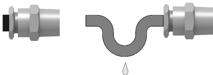
Рисунок 2.13 U-образная петля кабеля
