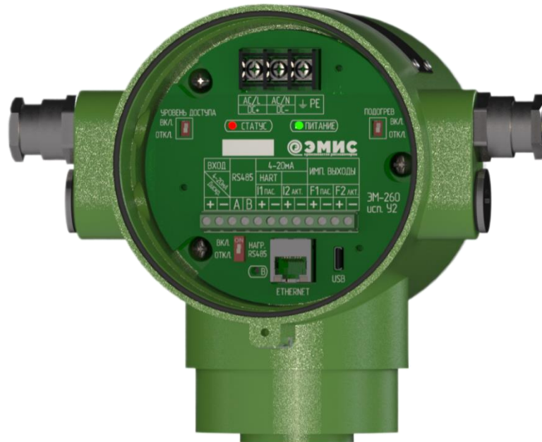
Рисунок 4.1. Клеммная колодка для подключения внешних цепей.
