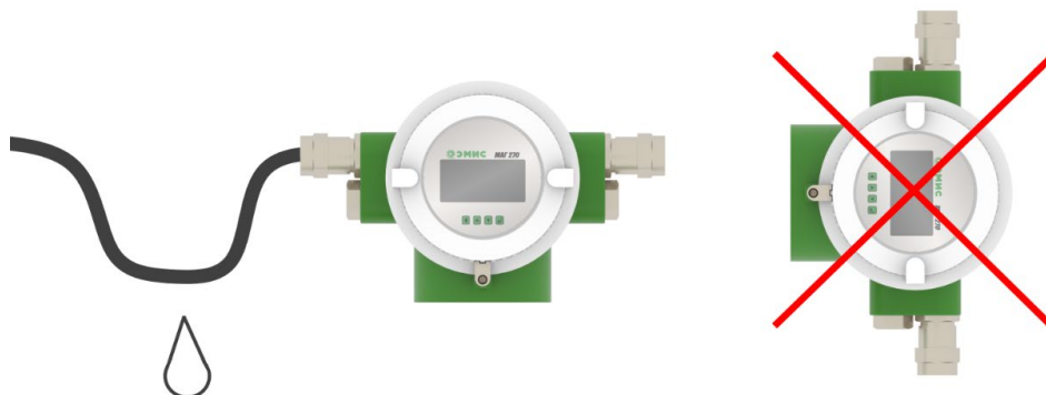
Рисунок 2.8 - Рекомендации по расположению кабелей и кабельных вводов
