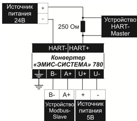
а) последовательное подключение
