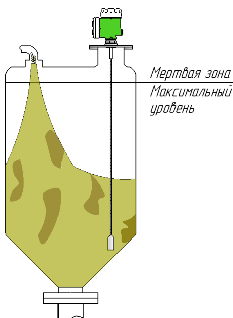
Рисунок. 2.2 – «Мёртвая зона» уровнемера
