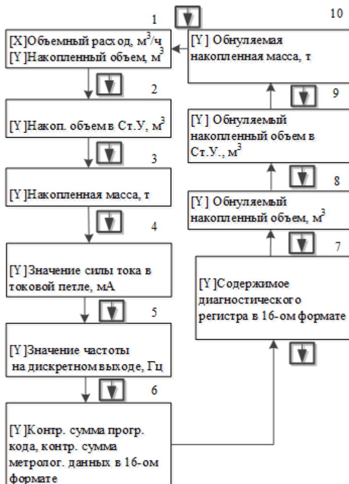
Рисунок 9.2 – Структура выбора параметра нижней строки основного меню
