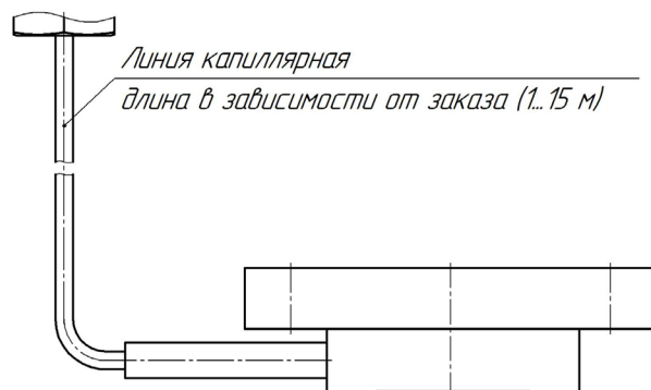
Рисунок Д.7 – Габаритные и присоединительные размеры специального фланцевого исполнения датчиков давления ЭМИС-БАР 173 и 175. Со штуцерным разделителем сред (код WL)
